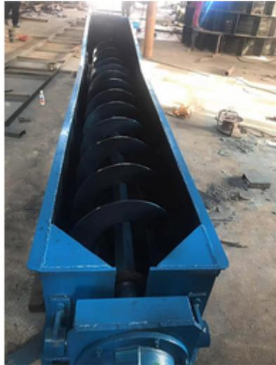
螺旋洗砂机是洗砂机的一种，主要通过设备内的螺旋装置对砂石料进行搅拌，从而使砂石料中的泥土与水进行混合，从设备上的流口排出，而砂石料则在螺旋装置的作用下被逐步筛选，从顶端的出料口排出，从而实现了砂石料的清洗筛选效果。螺旋洗砂机适用于冶金、建材、水电等行业的洗选、分级、除杂等作业，用于细粒度和粗粒度物料的洗选作业。对建筑用砂、筑路用砂石尤为适宜。螺旋砂石洗选机功率消耗小、洗净度高。密封结构好、全封闭传动装置、可调式堰板，确保了产品耐用、清洗、脱水效果好、细粒产品保持稳定等特点。电动滚筒，是一种将电机和减速器共同置于滚筒体内部的新型驱动装置。昌吉型号齐全洗砂设备哪家好
